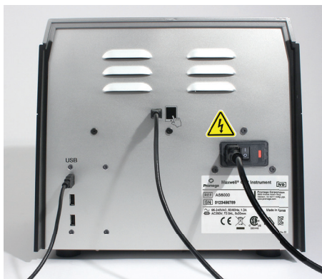
Figura 3. Vista trasera del Maxwell® CSC Instrument. En la parte trasera del instrumento se pueden ver el interruptor de encendido/apagado, el cable de alimentación, el conector, el puerto de comunicación USB entre el instrumento y la tableta, y tres puertos de comunicación USB adicionales para la conexión de dispositivos periféricos (p. ej., el lector de códigos de barras).
